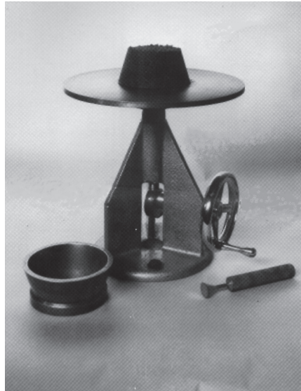
Figura 1.1.2: Aparato de ensayos de fluidización y accesorios
