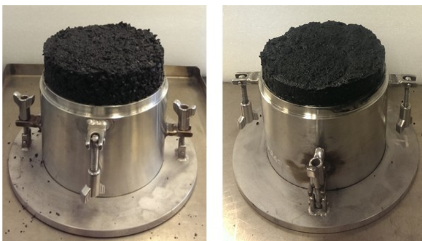
Figure 1.5.7 – Images montrant des essais valables pour une portion d'essai partiellement saturée (gauche) et une portion d'essai quasiment pleinement saturée (droite)
