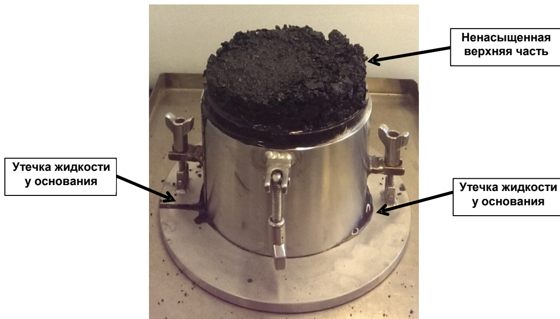
Рис. 1.5.8. Испытанием продемонстрирована утечка жидкости у основания цилиндрической формы, что свидетельствует о миграции влаги
