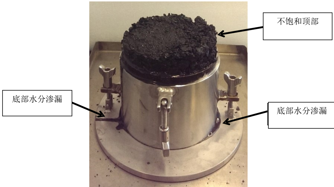
图 1.5.8: 试验显示从圆筒模底部出现水分渗漏以表明水分渗移
