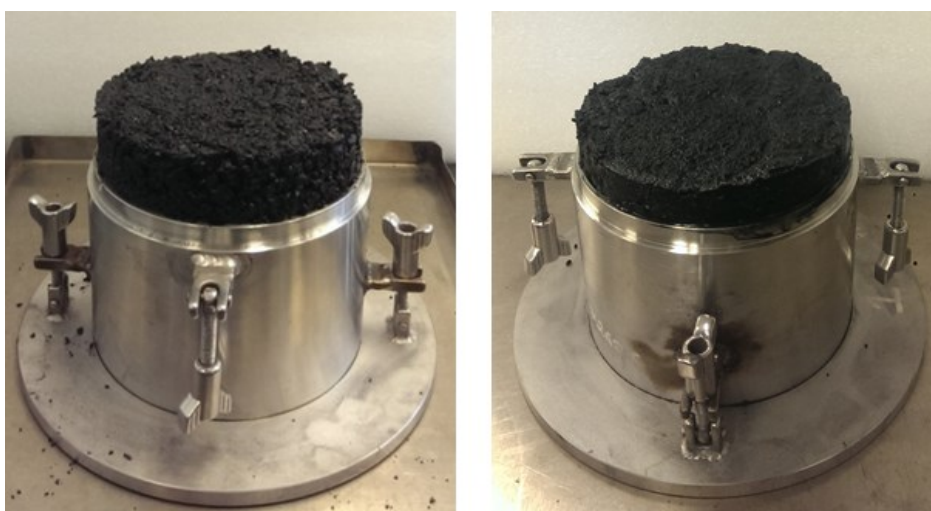
Figura 1.5.7: Fotografías en las que se muestran ensayos válidos con una porción de ensayo parcialmente saturada (izquierda) y una porción de ensayo saturada casi en su totalidad (derecha)
