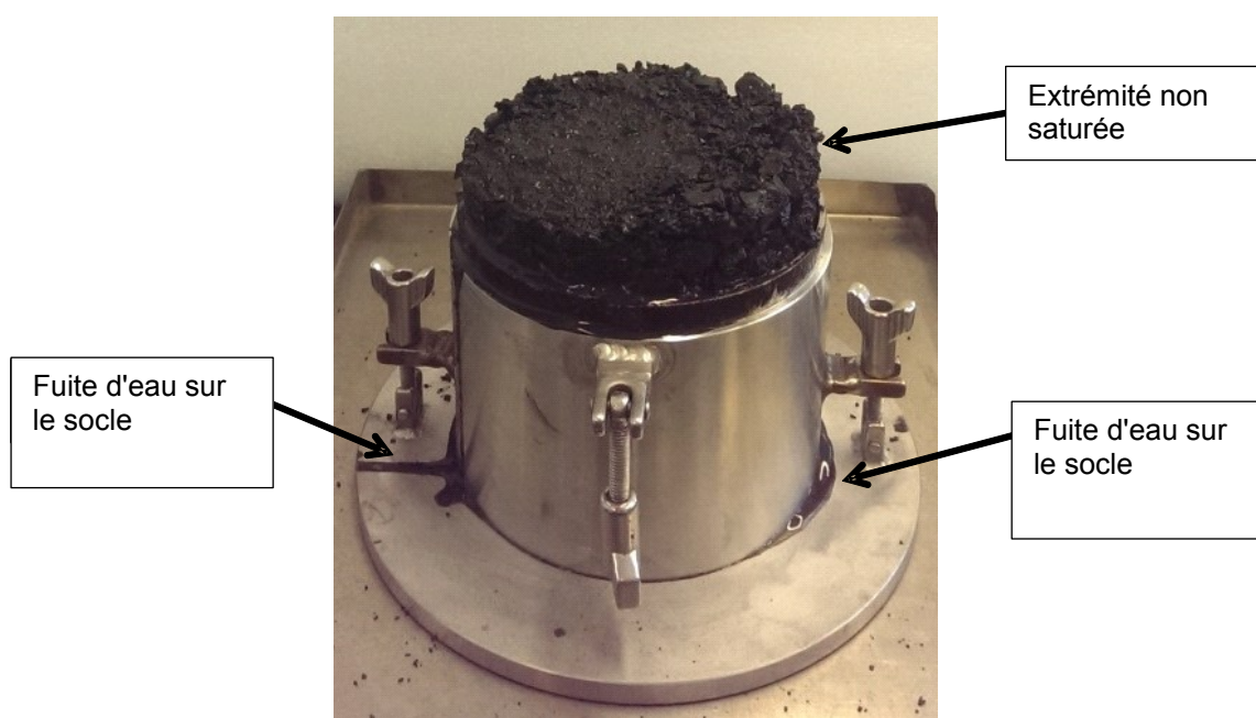
Figure 1.5.8 – Essai montrant une fuite d'eau sur le socle du moule cylindrique qui indique une migration de l'humidité
