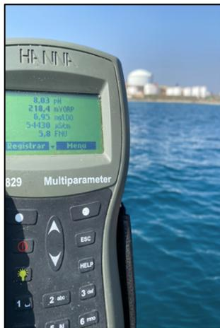
Cuando una estación tiene asociada las matrices de agua y sedimento, y el monitoreo de ambas matrices se realiza en días diferentes, se deben realizar las mediciones *in situ* de la matriz acuosa empleando la sonda multiparámetro HANNA HI-9829 en los 2 días diferentes.
