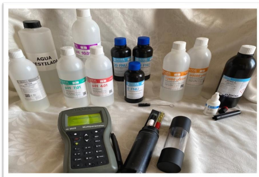
Figura Nº 21. Imagen general de los insumos utilizados para la calibración del equipo multiparamétrico para mediciones en la columna de agua.
