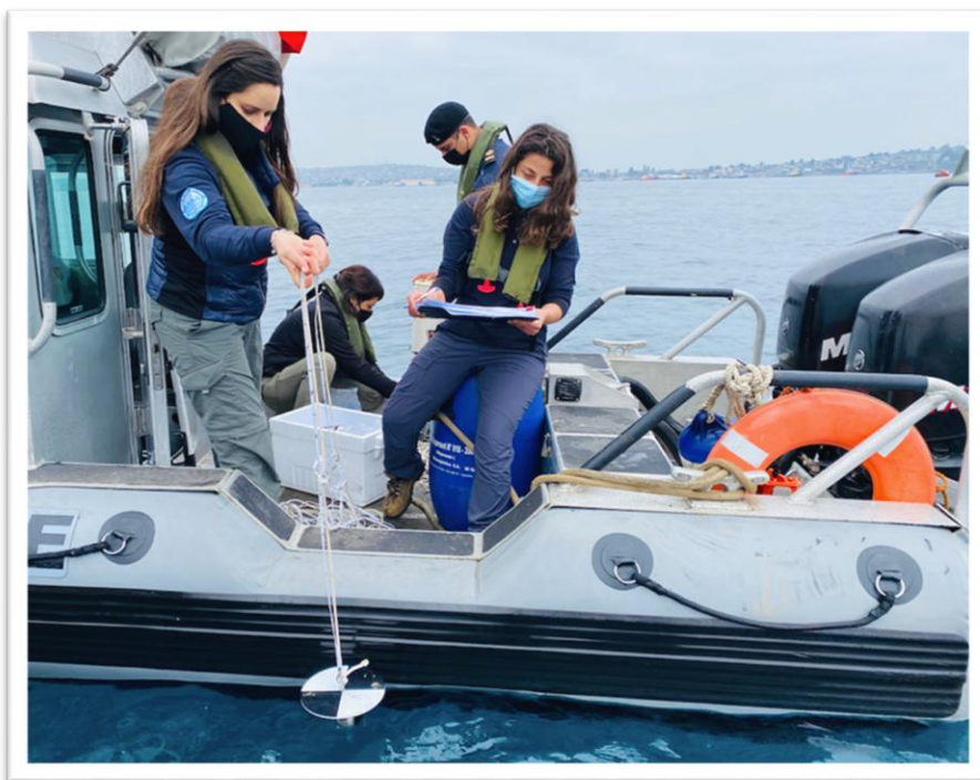
Figura N° 20. Profesionales efectuando el descenso del disco Secci para estimar la visibilidad.
