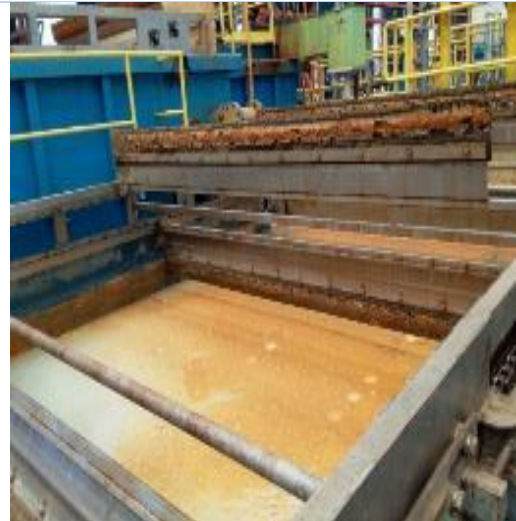
Anexo Imagen 41: Operación de celdas de flotación, para la coagulación y flotación sólidos.
