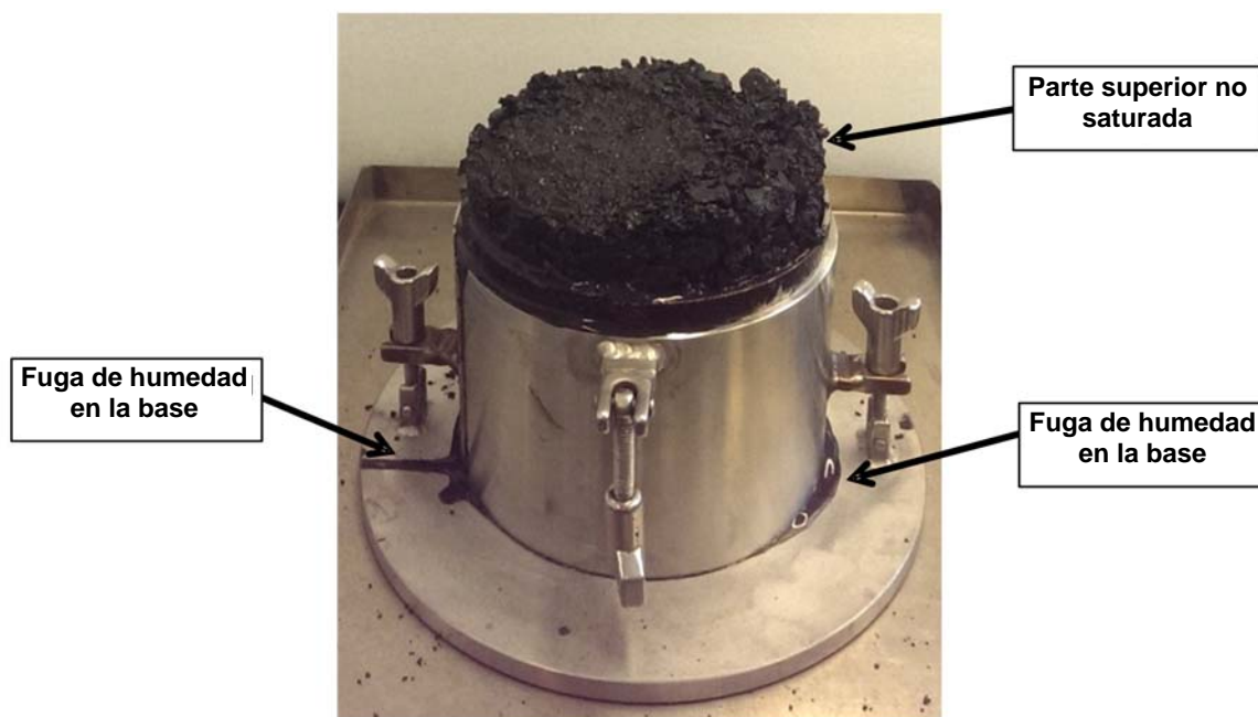
Figura 1.5.8: Ensayo en el que se muestra una fuga de agua procedente de la base del molde cilíndrico, lo que indica migración de la humedad
