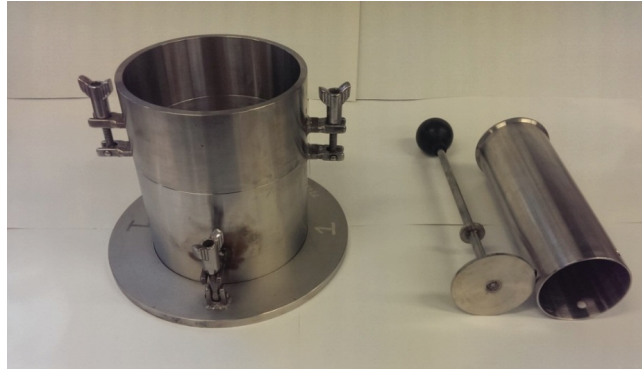
Figura 1.5.5.1.3.1: Ejemplo de aparato de ensayo Proctor/Fagerberg, del percutor y de la guía del percutor
