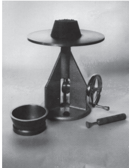
Figura 1.1.2: Aparato de ensayos de fluidización y accesorios
