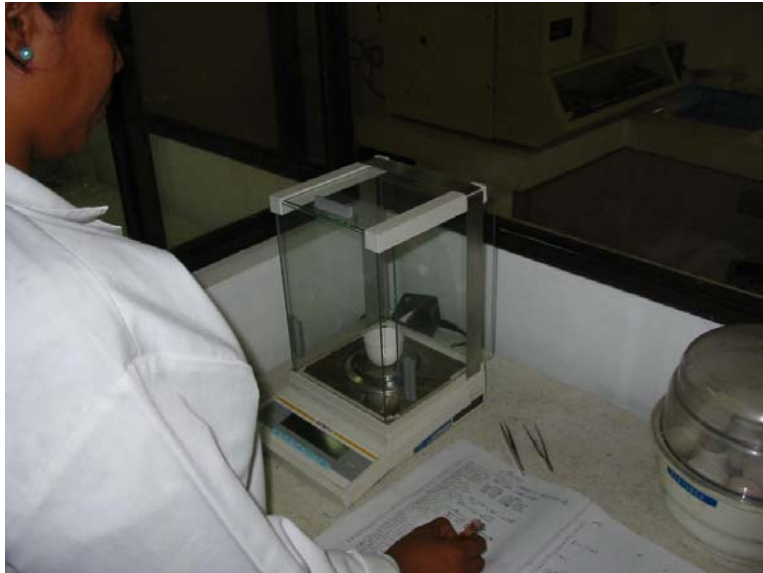
Figura 13. Balanza analítica empleada para la determinación de sólidos en muestras de agua.
